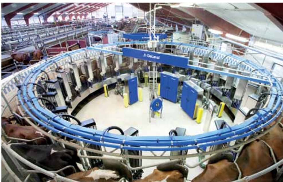
NFO-omriktarna styr drivningen av den nya robotiserade mjölkningskarusellen där 500 kor kan mjölkas helt automatiskt tre gånger om dagen.
